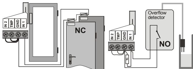
Пример подключения H3 ... и HP kontaktov
